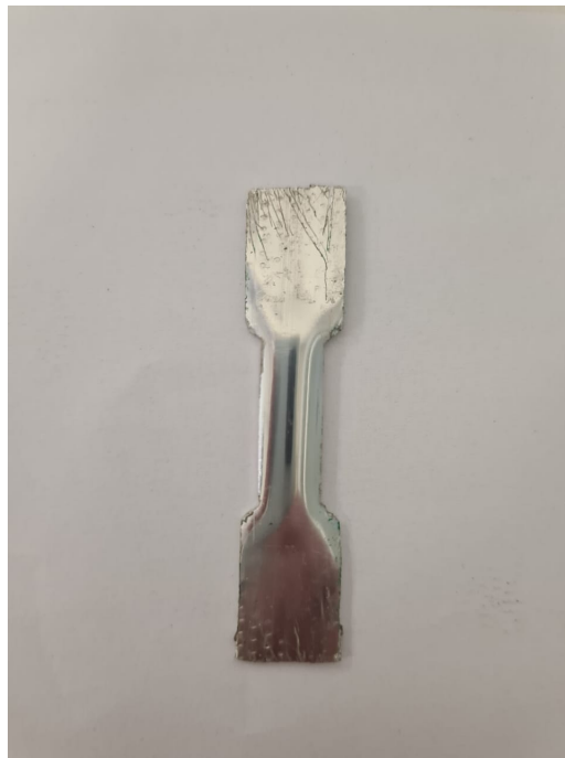
Figura 4: Corpo de teste retirado do tubo de alumínio, no formato "borboleta".
